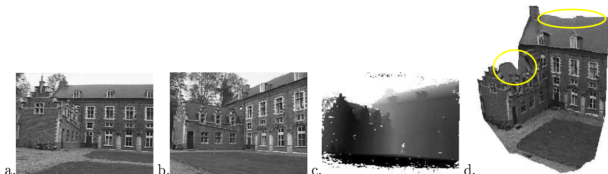
FIG. 4.18 – a. et b. Première et dernière image de la séquence utilisée par [Koch et al.98] ; c. carte de profondeur obtenue ; d. modèle reconstruit texturé .
