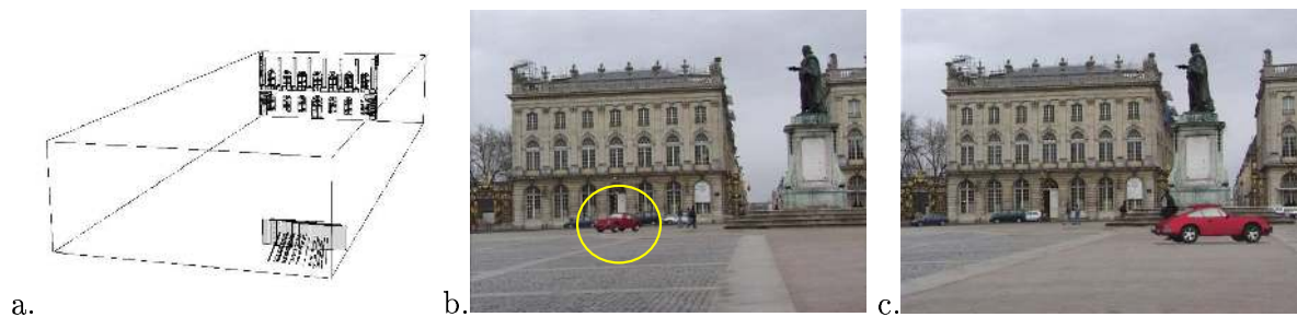
FIG. 2.13 – a: Trajectoire de la caméra retrouvée avec la méthode hybride. b et c: Deux images de la séquence avec l'incrustation d'une voiture.
