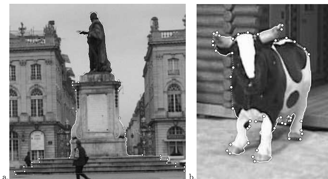
FIG. 7.1 – Deux résultats d'utilisation de l'outil Intelligent scissors : les points correspondent aux clics souris, les traits pleins aux contours retrouvés automatiquement et les traits pointillés aux segments de droite définis quand la méthode automatique a échoué.
