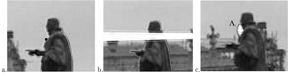
FIG. 6.19 – a : Un point du contour dans une image-clé; b : les droites épipolaires associées à ce point dans l'autre image-clé; c : les reprojections associées à ce point dans une image intermédiaire.
