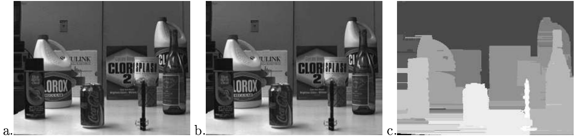
FIG. 4.11 – a. et b. Paire stéréoscopique utilisée par [Birchfield et al.98]; c. Carte de profondeur obtenue.
