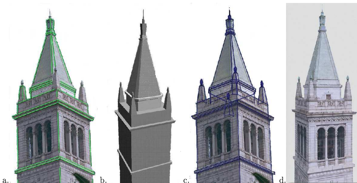
FIG. 4.25 – a. Une des images utilisées dans Façade et les segments ayant un correspondant dans le modèle construit par l'utilisateur (b); c. Reprojection de ce modèle dans l'image; d. Vue du modèle texturé (images extraites de [Debevec et al.96]).
