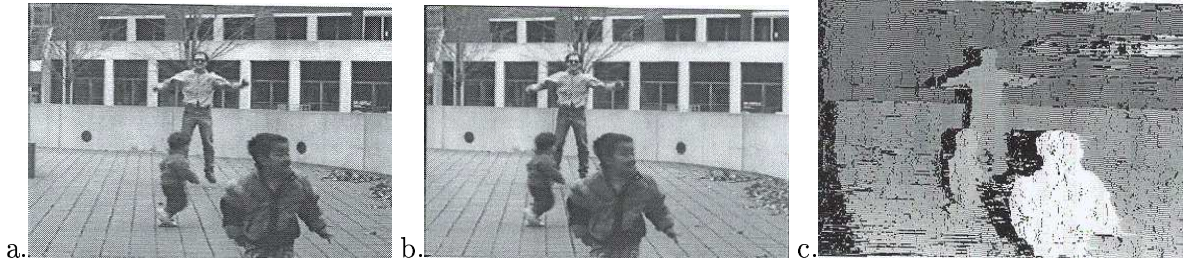
FIG. 4.10 – a. et b. Paire stéréoscopique utilisée par [Intille et al.94]; c. Carte de profondeur obtenue (les zones noires sont les occultations détectées).
